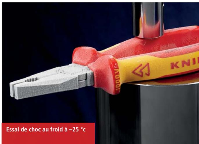
Essai de choc au froid à -25 °C
