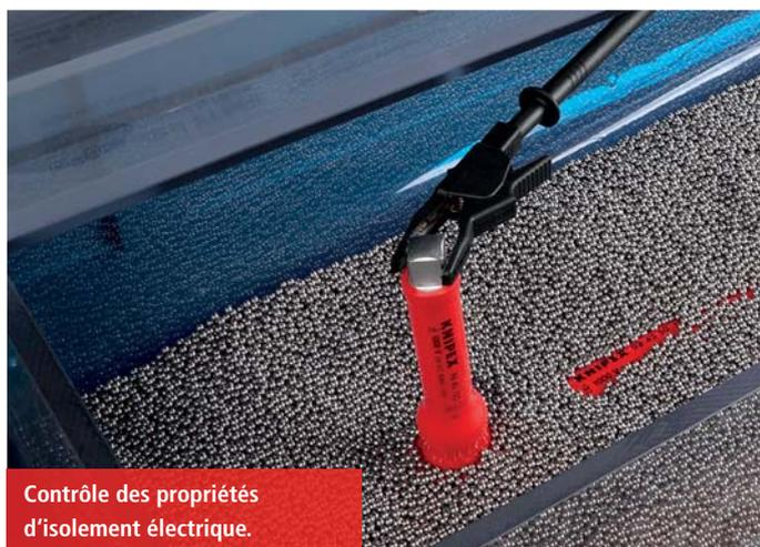
Contrôle des propriétés d'isolement électrique.
